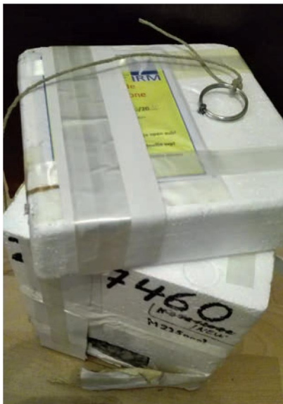
Foto hierboven: de gondel van de zelf "buitgemaakte" KMI-sonde (ozonsensor werd teruggegeven aan het KMI).
